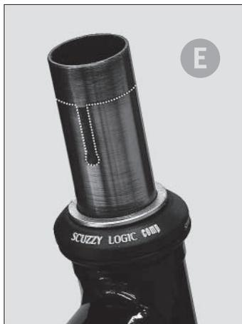
**E** Nun haben Sie eine saubere Kontur der Schnittkanten und der Bohrung im unteren Bereich. Innerhalb und entlang dieser Konturlinie wird nun **entsprechend den Erläuterungen und der Abfolge auf der Seite 17** gebohrt und gesägt:
