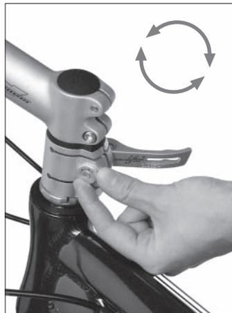
Öffnen Sie den Schnellspannhebel **3** vollständig.
