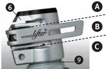
Der untere Bereich **C** des Speedlifter-Körpers **6** und der geschlitzte Stellring **9** werden von der M5-Innensechskantschraube **5** auf dem ungeschlitzten Bereich des Gabelschaftrohres fixiert. Der eingeschraubte, geschlitzte Stellring aus Aluminium **9** dient zur Einstellung des Lenkungslagers.
