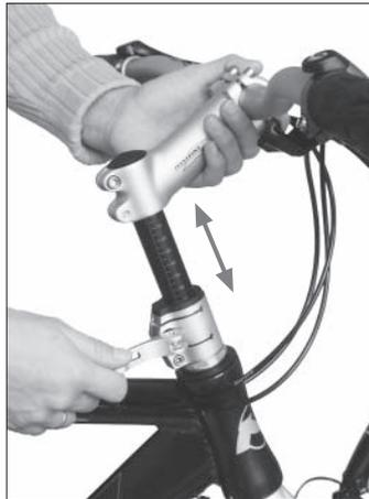
Öffnen Sie von Hand den Schnellspannhebel **8** des Speedlifter und bewegen Sie den Lenker in die gewünschte Position.
