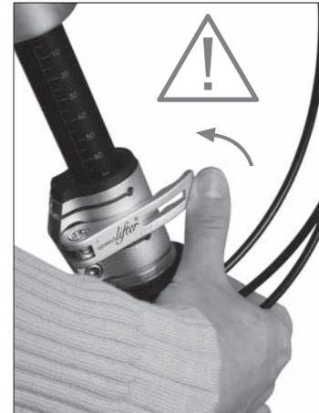
Der Schnellspannhebel **8** des Speedlifter muss während der Fahrt immer geschlossen sein!
